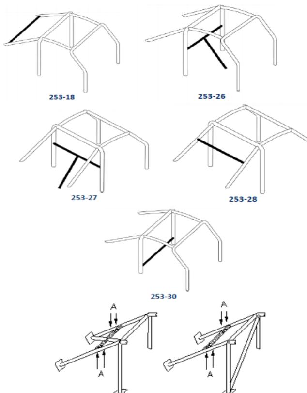
A – отверстия для крепления ремней Рис.253-66
