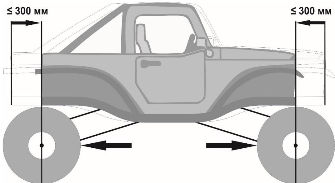
3.11.3. Разрешается снятие или подрезка задней части крыши автомобиля до средней стойки дверей. **Рис 14.** При этом обязательно наличие травмобезопасной перегородки, отделяющей отсек экипажа от задней части кузова. Перегородка должна быть выполнена из металла. Допускается наличие смотрового окна из монолитного поликарбоната толщиной не менее 3 мм или многослойного стекла типа "триплекс".
