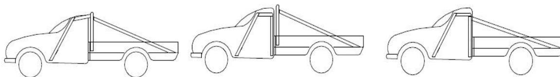
**1.4.2.** Каждая опора любой дуги или наклонных распорок должна включать усилительную пластину, толщиной, по крайней мере, 3мм.
